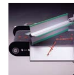
SP Separatore a palette Paddle separator
